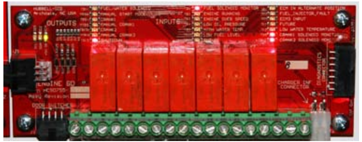
Tarjeta con relés de motor para conexiones en sitio que incluyen motores ECM y PLD
