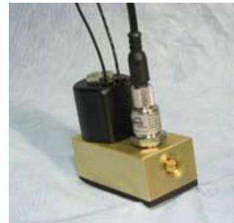
Conjunto de múltiple de 600 PSI con transductor de presión y válvula de solenoide de prueba, de 4000 PSI de presión de ruptura, probado individualmente a 1000 PSI. Disponible en controlador de FM y del CE solamente. La UL enumeró los controladores disponibles con el grado máximo de 290 PSI.
